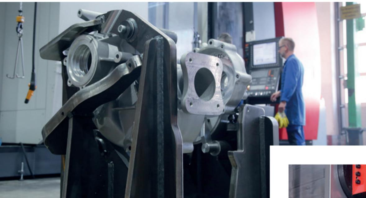
Électrobroche haute performance avec plage de vitesse de 50-15000 tr/min, puissance 46 kW et couple max. 170 Nm, axes B et C avec moteurs couples et capteurs de mesure, règles optiques sur les axes X, Y, Z en standard. Ces sont autant de caractéristiques qui font que les machines de la série MMV soient les centres d'usinage idéaux pour un fraisage à haut niveau et qui permettent la fabrication complète de pièces complexes avec d'excellents états de surface.
