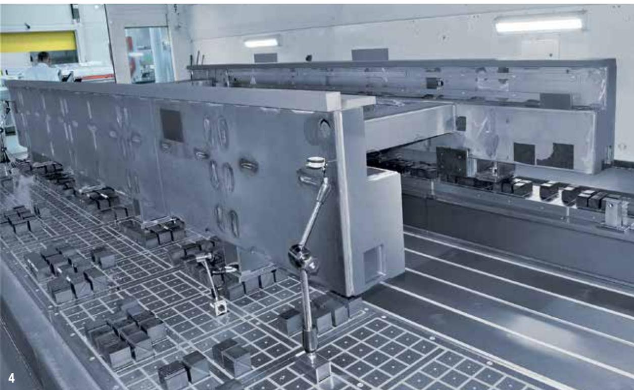
pesano circa 5 t, vengono realizzati in 12-16 ore con un'unica operazione di serraggio. La lavorazione completa avviene in tre fasi: sgrossatura (che prevede un tempo di lavorazione di circa 5 ore, comprensivo della fase distensiva dei componenti), pre-finitura (ovvero la fresatura di tutte le superfici, forature, filettature, ecc.) e finitura (lavorazione ad alta precisione delle superfici delle guide (planarità
