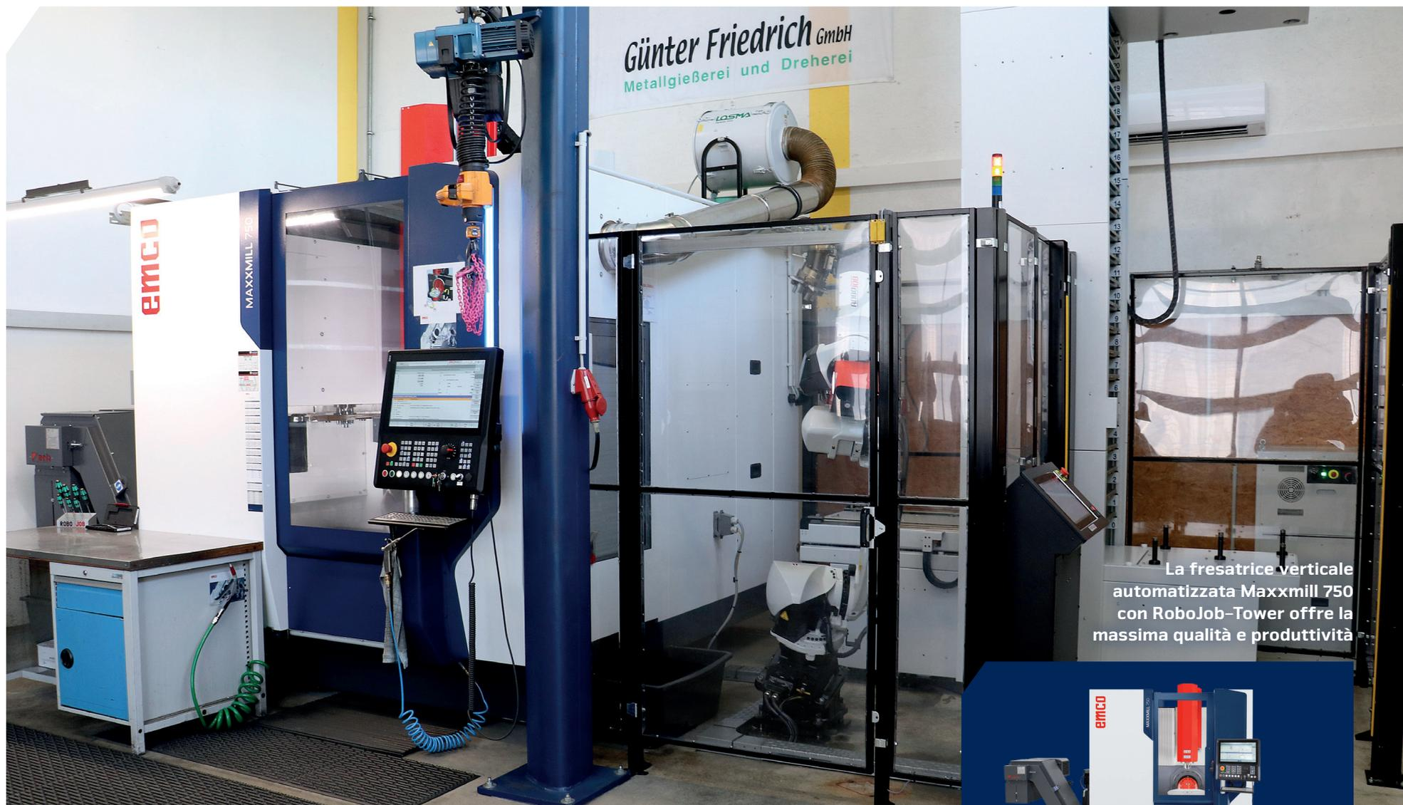
La fresatrice verticale automatizzata Maxxmill 750 con RoboJob-Tower offre la massima qualità e produttività
