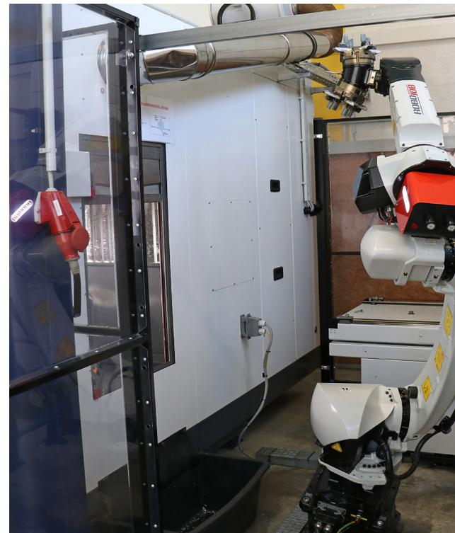
La soluzione Tower robotizzata di RoboJob, abbinata al Maxxmill 750 di Emco, consente di lavorare i componenti 24 ore su 24.
