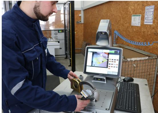
Friedrich verifica la precisione richiesta con controlli di qualità a campione. Grazie alla struttura estremamente rigida della macchina, l'Emco Maxxmill 750 raggiunge in modo affidabile un'elevata precisione nel range dei centesimi di millimetro e qualità superficiali di Rz = 1 µm nel funzionamento pratico.
