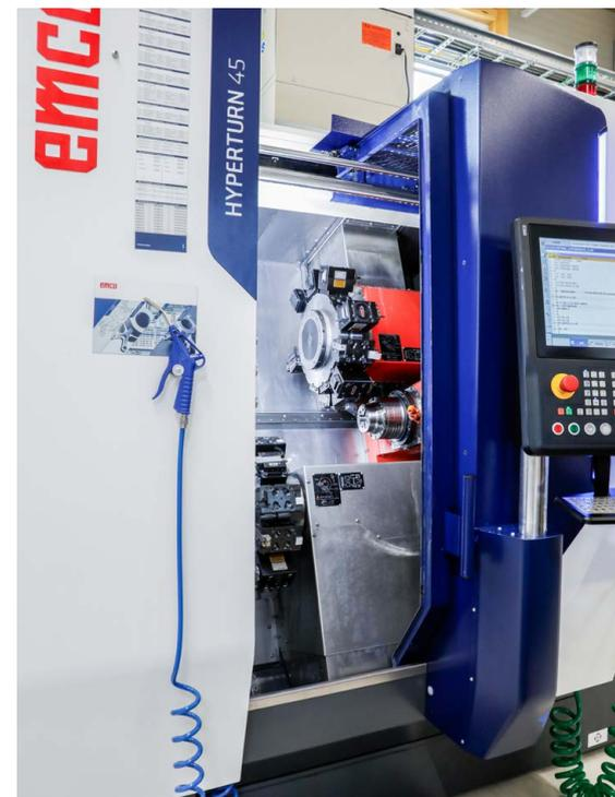
Il design verticale della HYPERTURN 45 G3, con letto inclinato di  $72^\circ$ , garantisce una buona caduta dei trucioli.
