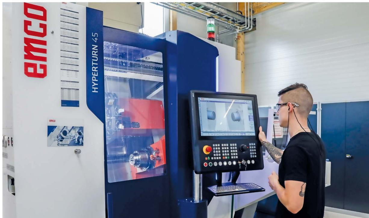
Secondo MSG, l'HYPERTURN 45 G3 si distingue per il suo design molto compatto, i potenti mandrini principali e contromandrini, gli azionamenti altamente dinamici in tutti gli assi e le due torrette portautensili BMT45P con utensili pilotati.
